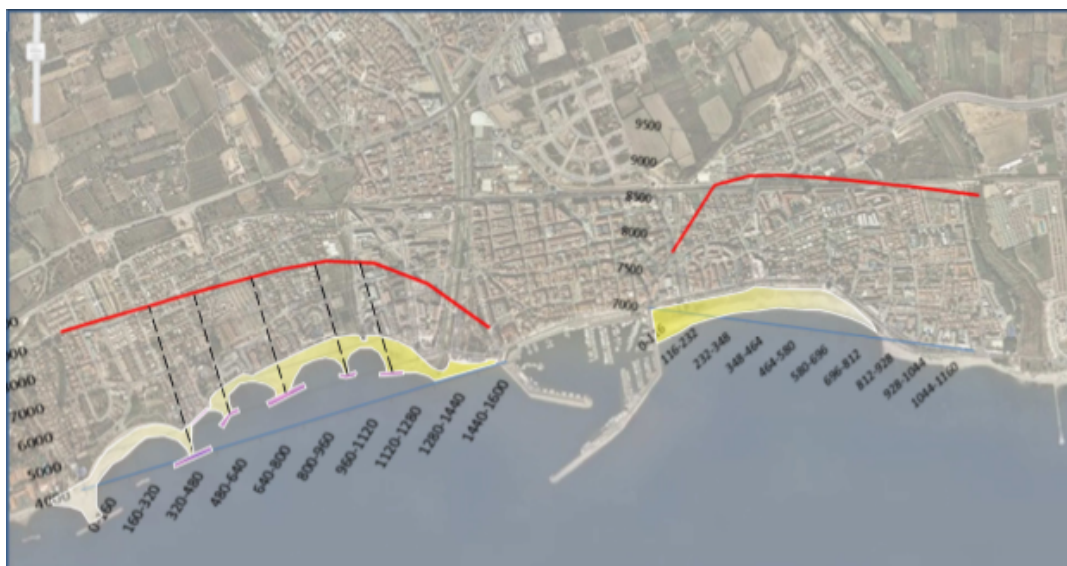
Figura 82: Resultats de l'acomulació de sediments en les diferents construccions de protecció del port de Cambrils.
