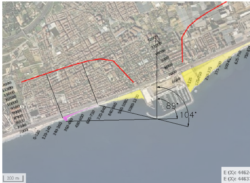
Figura 56: Rang d'angles de la protecció del port de Premià de Mar.
